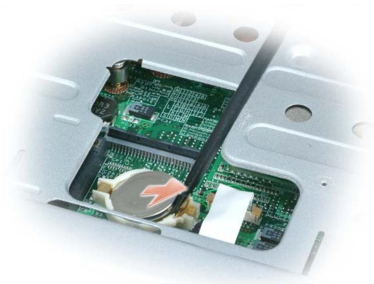
Quando si sostituisce la batteria, inserirla con un'angolazione di 30 gradi sotto il fermaglio con il polo positivo (contrassegnato dal simbolo [+]) rivolto verso l'alto, quindi spingerlo in posizione.
